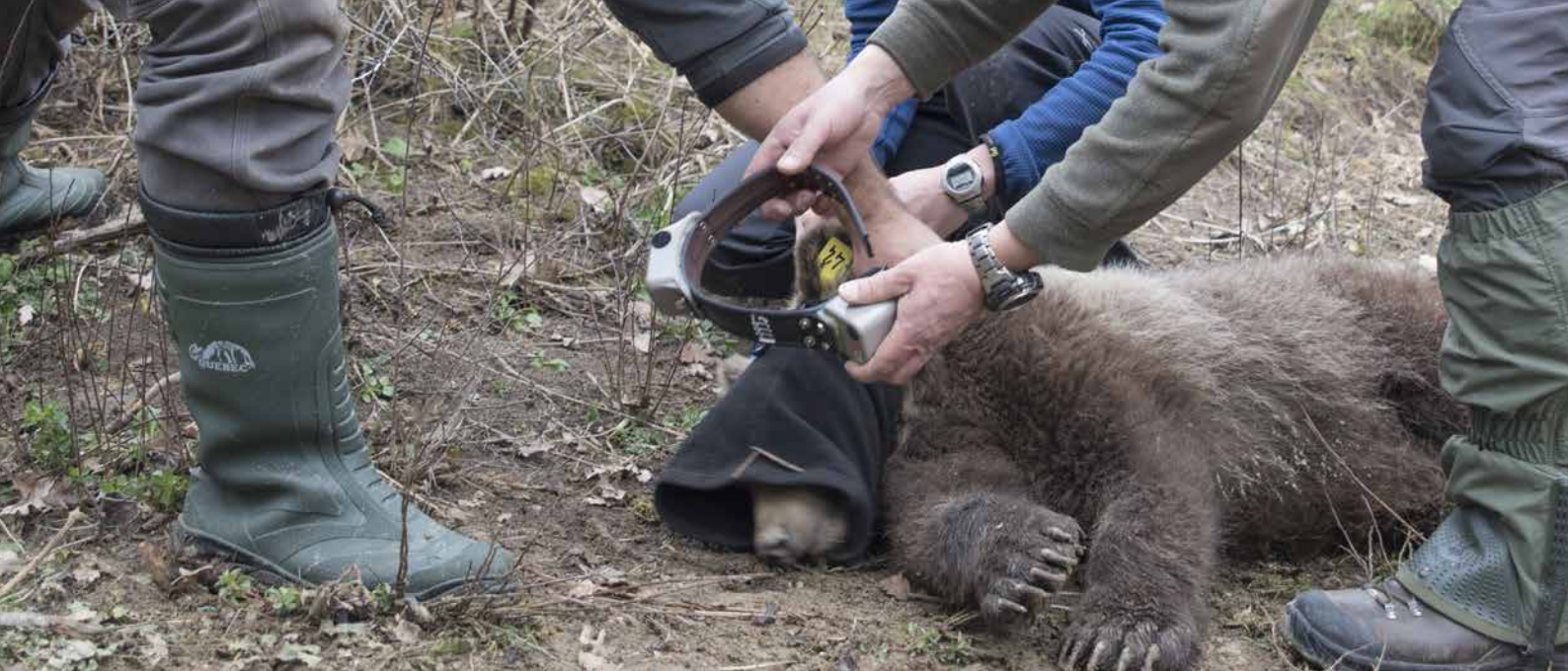
Foto 1: collare satellitare Iridium Vectronic tagliato e ricucito per uno sgancio meccanico.
